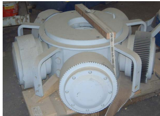
Фиг. 4. Гранулираща машина с плоска матрица от "California Pellet Mill" USA
