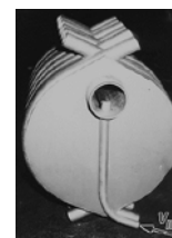
Фиг.3 Димоотводна тръба и тръба за третичен въздух Fig.3 Flue and tertiary air pipe
