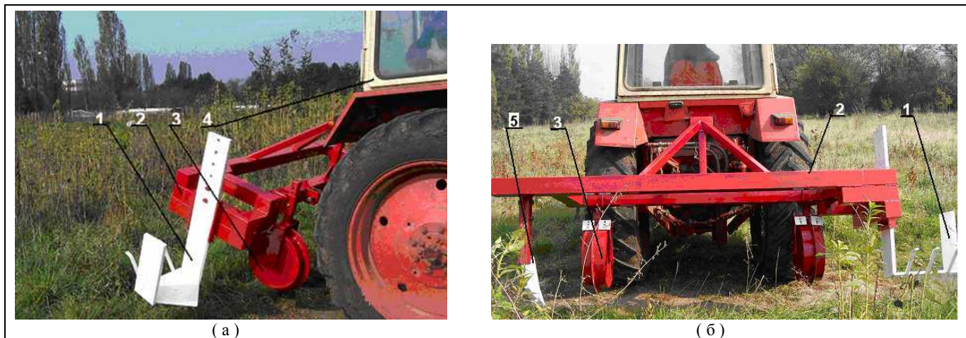
Фиг.2 Работна земеделска машина за изваждане на фиданки от разсадници МИФ-1У
