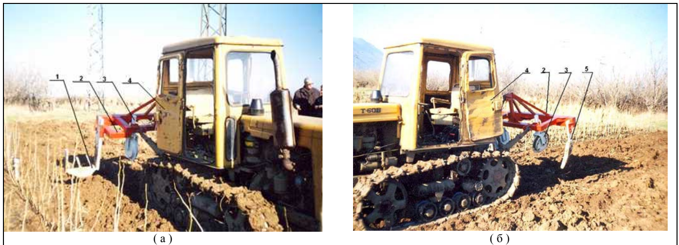
Фиг.1. Работна земеделска машина за изваждане на фиданки от разсадници МИФ-1
